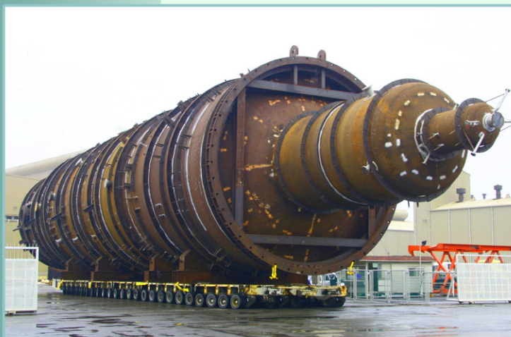
▲C9701 真空塔 Vacuum Tower SA516-70 + 316L \phi 10.2 m x 60.7 m L x 843 Ton
