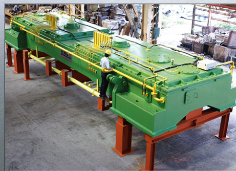
厚板用縦型エッジャー用歯車減速機 Plate Mill Vertical Edger Gear Reducer (2 × 1200 KW, 150 Tons)
