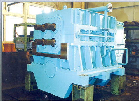
ステンレス鋼用冷間圧延機 Cold Mill for Stainless Steel (4100 KW, 22 Tons)
