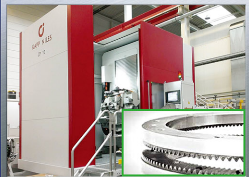
正面歯車研削盤 (最大 1000mm) Tooth Grinding of Hirth Serration
