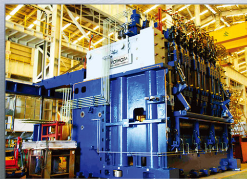
厚板用クロップシャー設備 Plate Mill Crop/Divide Shear Equipment (2 × 650 KW, 500 Tons)
