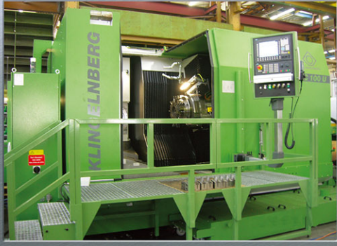
内歯・外歯用複合大型歯車研削盤 (最大 4000mm) Ø4.0 Meter Profile Gear Grinding Machine for External & Internal Gear
