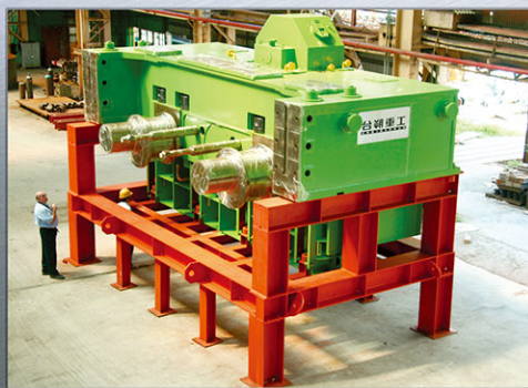
厚板用クロップシャー歯車減速機 Plate Mill Crop/Divide Shear Gear Reducer (2 × 650 KW, 153 Tons)
