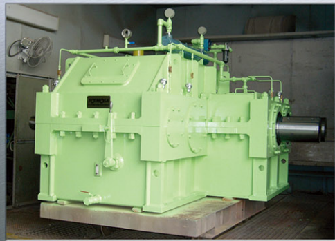
ミキシングローラー用歯車減速機 Mixing Roll Gear Reducer (1500 KW, 18 Tons)
